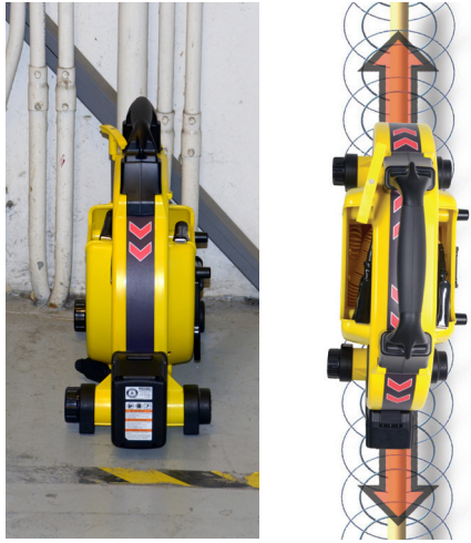
Рисунок 4 – Индукция с помощью RIDGID SeekTech ST-33QR
